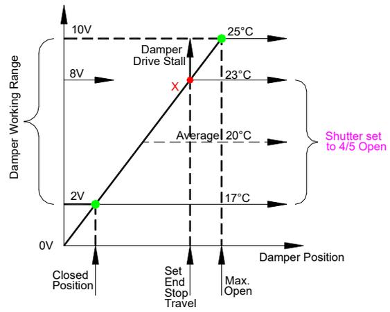
FIG 29B PROPORTIONAL DAMPER TEMPERATURE OPERATION
