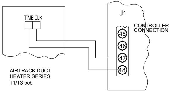
FIG 26: HEATER INTERLOCK CONNECTION
