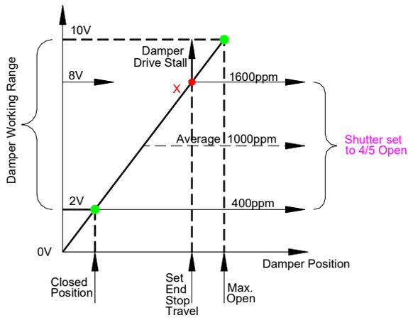
FIG 29A PROPORTIONAL DAMPER CO<sub>2</sub> OPERATION
