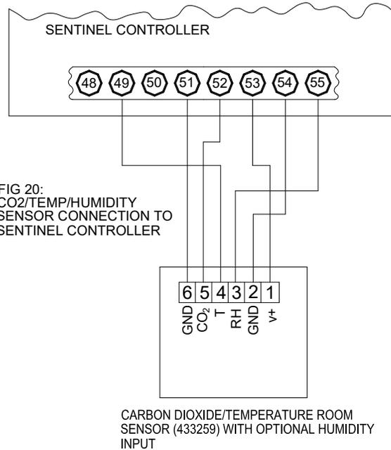
FIG 20: CO2/TEMP/HUMIDITY SENSOR CONNECTION TO SENTINEL CONTROLLER
