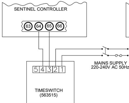
FIG 13: TIMESWITCH CONNECTION DIAGRAM
