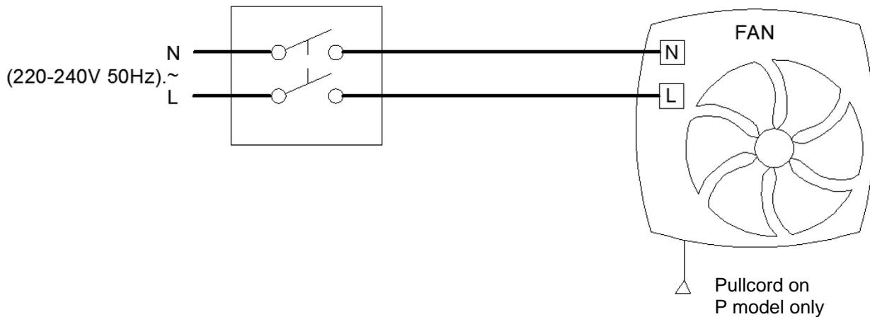
Fig. 9. T/HT wiring diagram
